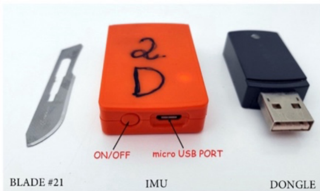
Figura 17. La apariencia externa de una IMU y la llave de conexión inalámbrica. Fuente: (Figueirinhas y cols., 2022)
