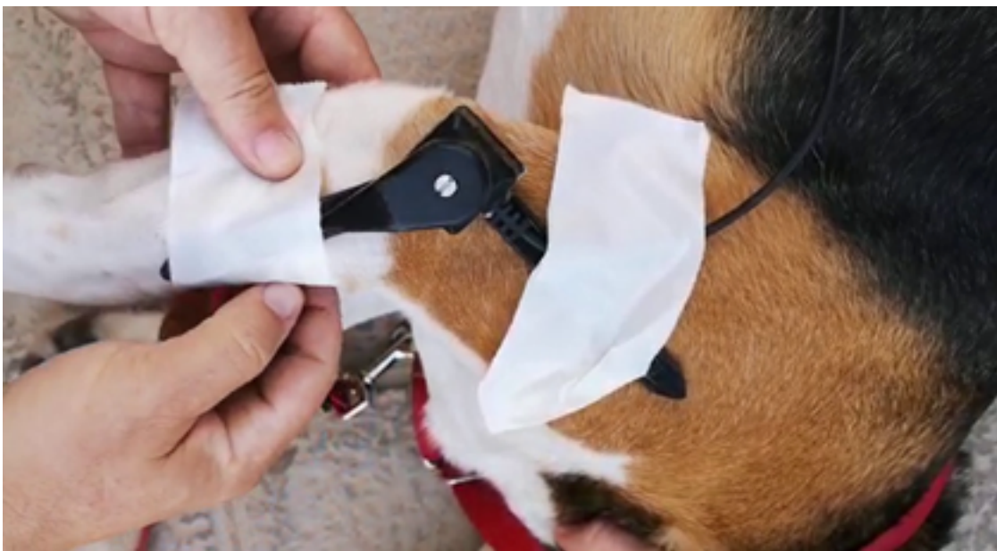
Figura 16. Colocación de un electrogoniómetro sobre la articulación del codo. Fuente: Hospital Clínico Veterinario de la ULPGC
