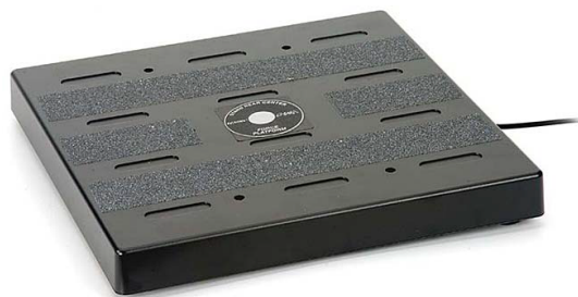
Figura 13. Plataforma dinamoétrica de fuerza con 4 sensores de la marca Pasco®
