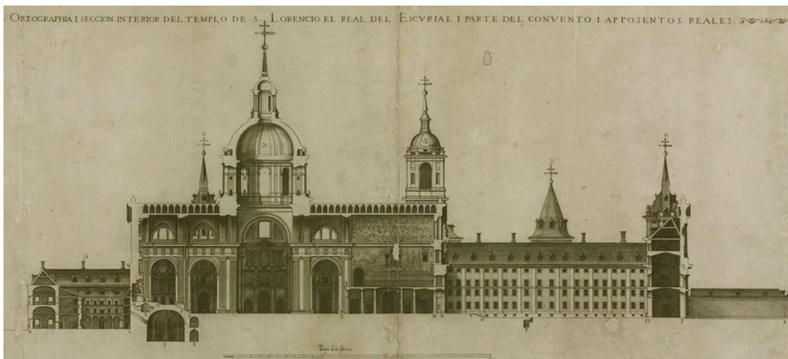
Fig. 51 Quinto Diseño, Sección longitudinal del templo, palacio y convento, 1587, buril sobre cobre. Inscripción en la parte superior: "ORTOGRAPHIA I SECCION INTERIOR DEL TEMPLO DE S. LORENZO EL REAL DEL ESCVRIAL I PARTE DEL CONVENTO I APPOSENTOS REALES" Inscripción a pie de imagen: "Con el privilegio del summo pontífice, y emperador, y rey de España, y Francia y de los demás potentados, y principes, christianos, y de la Señora de Venecia".
