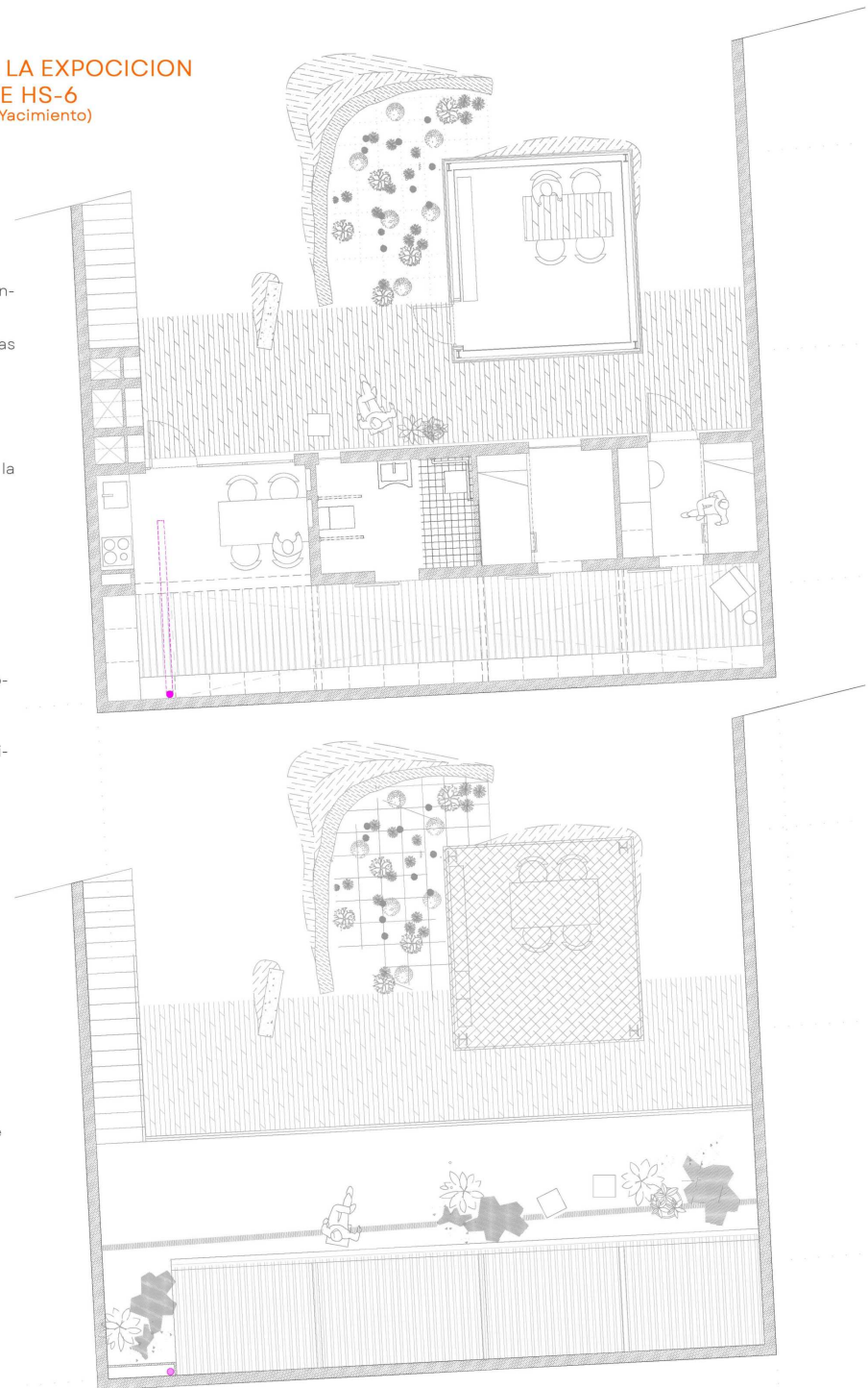
1.Tubo corrugado de polietileno de alta densidad (PEAD/HDPE) color negro, de 110 mm de diámetro nominal, con perforado total a 360° en el valle del corrugado, suministrado en rollos de 50 m, para la captación del radón.
