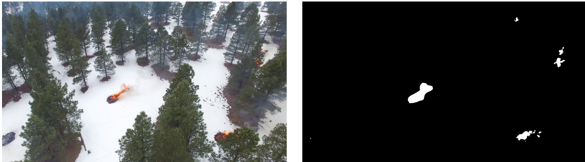
Ilustración 5.10: Comparación de una imagen RGB capturada por la cámara DJI Phantom 3 del dataset FLAME y su respectiva máscara binaria etiquetada como “fuego”.
