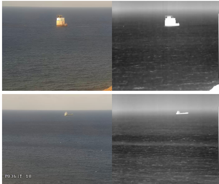
Ilustración 5.17: Imágenes RGB asociadas a su respectivo frame en IR obtenidas mediante la cámara PTZ proporcionada por QAISC y PLOCAN. Las diferencias mínimas entre imágenes del mismo frame se deben a variaciones en las lentes óptica y térmica, como el tamaño del sensor o la distorsión.
