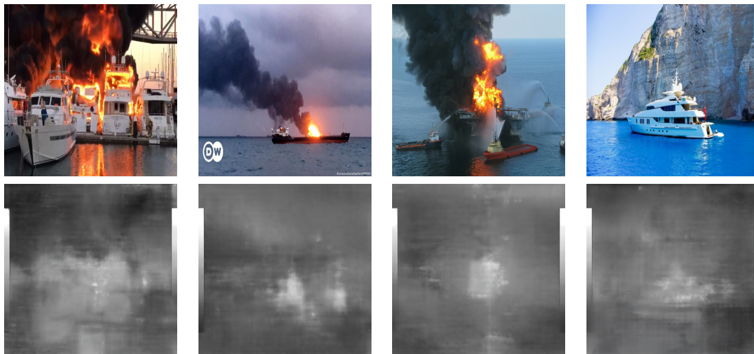
Ilustración 5.18: Resultados de transformación de dominios RGB a imágenes térmicas mediante Pix2Pix, siendo la fila superior las imágenes RGB reales y la fila inferior la transformación generada.
