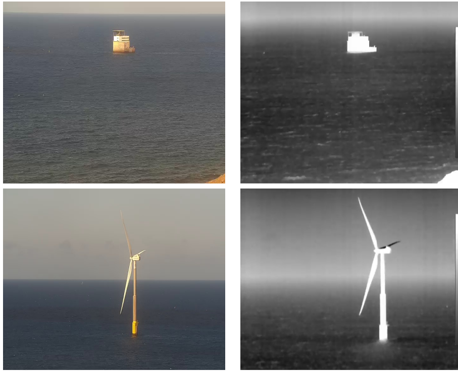
Ilustración 5.1: Imágenes capturadas por la cámara PTZ Biespectro térmico-óptica de Hikvision , mostrando comparaciones entre el sensor óptico (izquierda) y el térmico (derecha). La fila superior corresponde a la Plataforma Oceánica de Canarias (PLOCAN) y la fila inferior a un aerogenerador .
