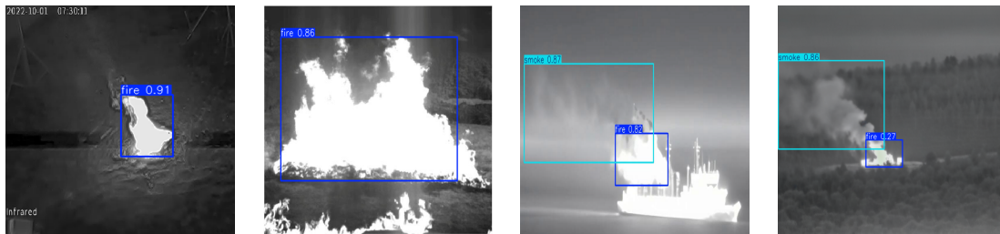
Ilustración 5.33: Ejemplos de detecciones predichas por el modelo YOLOv8n entrenado con imágenes reales de CORSICAN y generadas sintéticamente con Juggernaut XL. Se observa cómo patrones de fuego reales que son grabados de manera cercana pueden ser detectados y algunas imágenes de otros entornos puede llegar a detectar humo y fuego.
