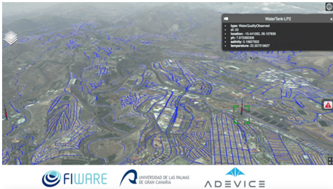
Figura 7.18: Recuperación de datos del sensor con la aplicación Smartwater. Las líneas azules representan las tuberías de la red de agua (Fernández Moniz et al., 2020).
