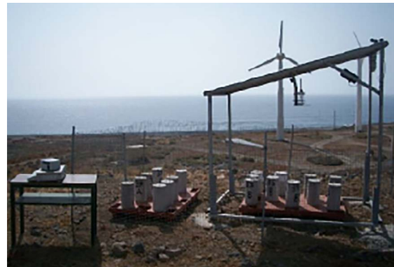
Figura 2. Probetas cilíndricas en estación de ensayo.
