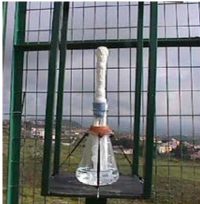
Figura 3. Dispositivo de vela húmeda para la captación de cloruros del aerosol marino.
