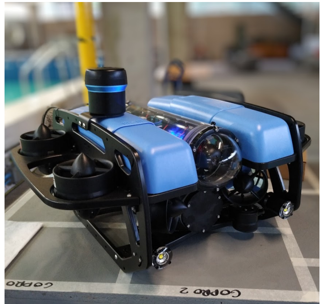
Figura 2: Imagen del BlueROV2 en su configuración pesada.
