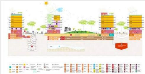
1. **LAS CUBIERTAS** /// EL ECOBARRIO TENDRÁ UN ALTO PORCENTAJE DE AUTOSUFICIENCIA ENERGÉTICA, APROVECHANDO LAS CUBIERTAS PARA LA CAPTACIÓN DE ENERGÍA Y AGUA.
