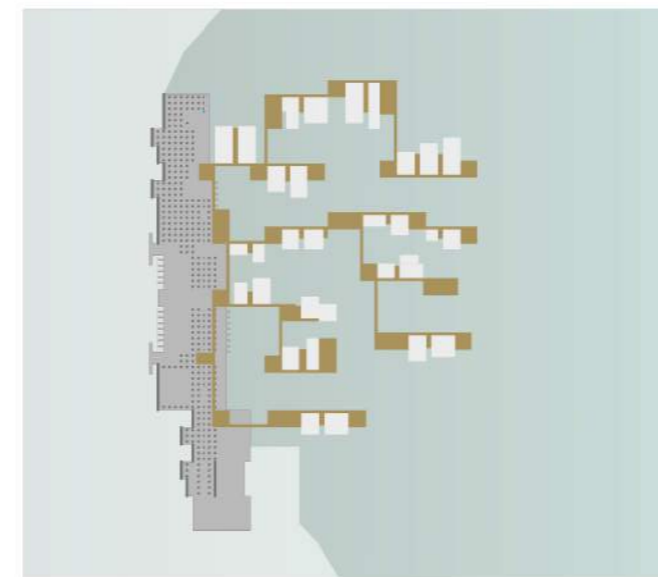
8 | DESARROLLO DEL SISTEMA DE PASARELAS | En este paso se construyen los elementos de conexión que se ubican apoyados en los pilotes de madera.
