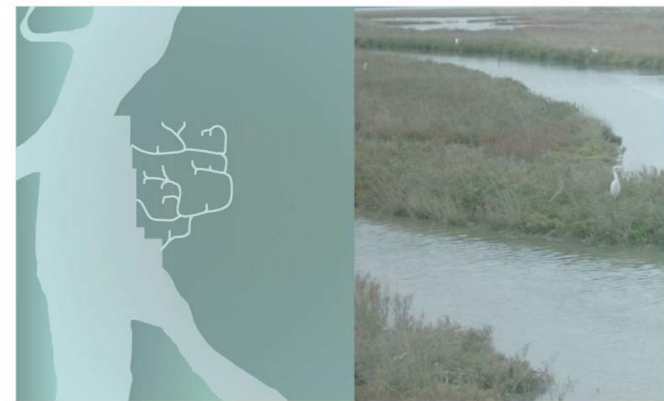
2 | RELLENO DEL CANAL SECUNDARIO | Utilizando la tierra de la excavación se rellena el canal secundario situado al oeste de la isla para fomentar el desarrollo continuado del velme y barene.
