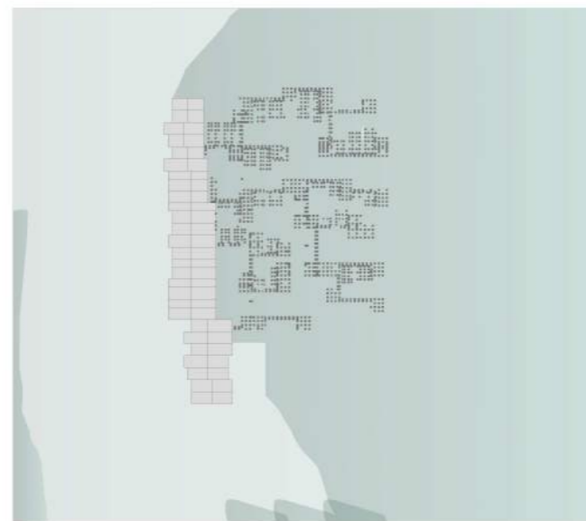
5 | TRAÍDA Y COLOCACIÓN DE CAJONES | Los cajones que configuran el dique se traen flotando y se depositan en el lugar indicado rellenándose de agua.
