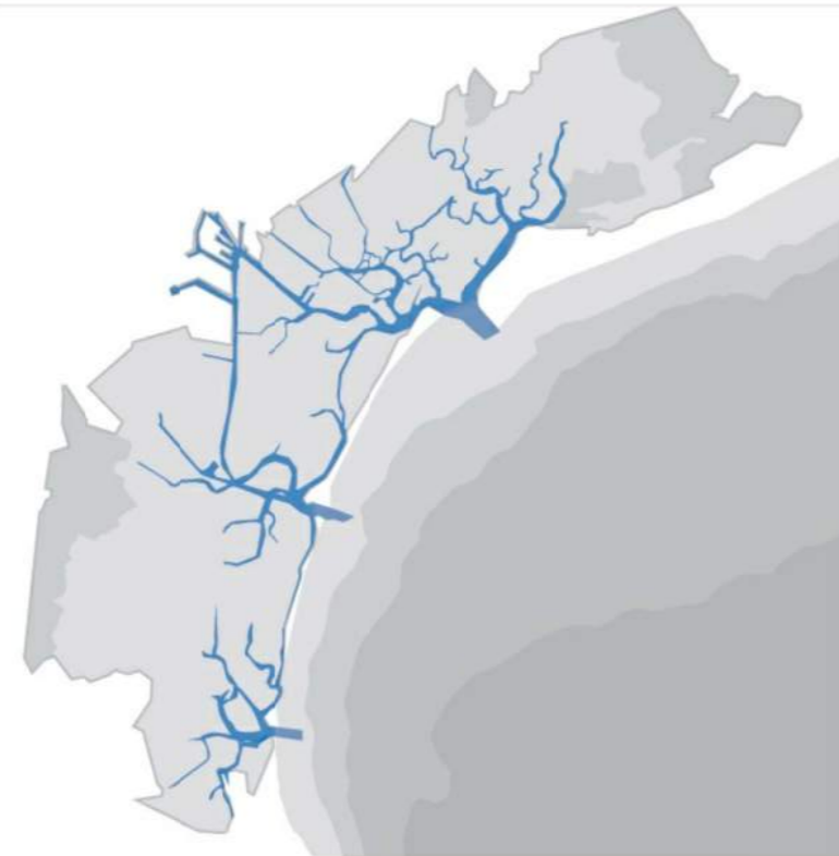
CANALES Divididos en principales y secundarios, son la estructura básica de la Laguna. Además de ser la principal vía de comunicación interna, aseguran el intercambio de agua entre las zonas interiores y el mar.
