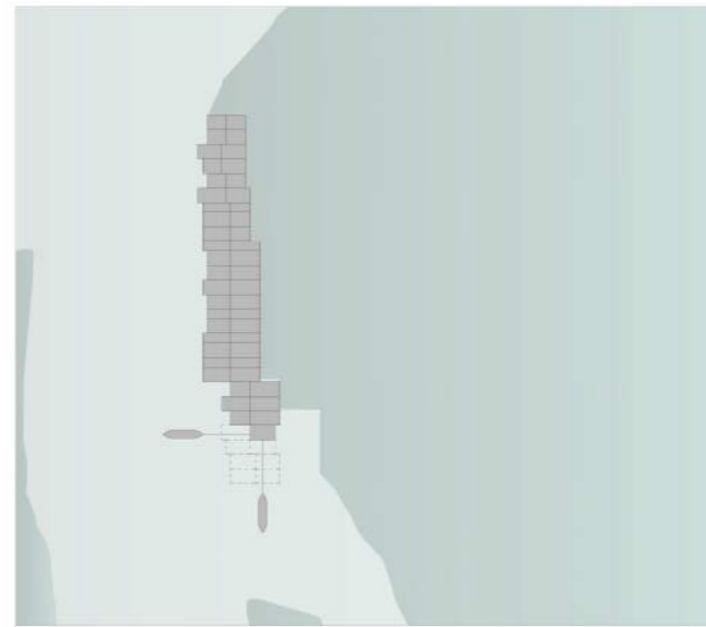
4 | TABLESTACADO Y EXCAVACIÓN | Se realiza un tablestacado en el perímetro diseñado y se excava preparando un fondo de encachado.
