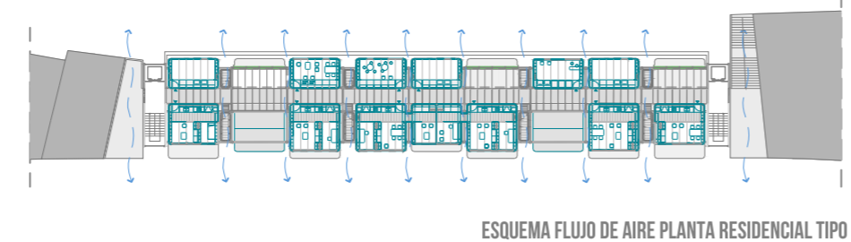
ESQUEMA FLUJO DE AIRE PLANTA RESIDENCIAL TIPO
