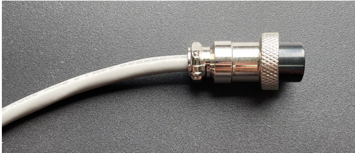
Figura 6.12. Resultado final del montaje del conector hembra
