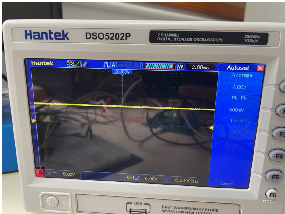
Figura 7.4. Medida de 7 V a la salida de la red de conversión
