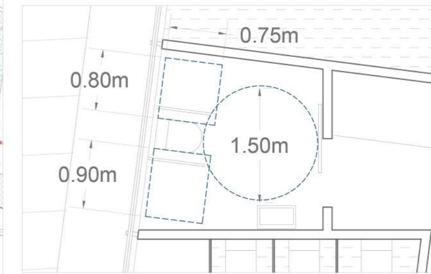
Aseo accesible / Accessible toilet
