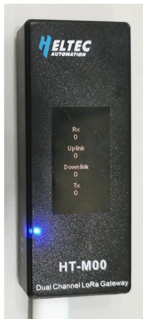
Figura 55 Interfaz de estado de los enlaces del gateway HT-M00 [40].
