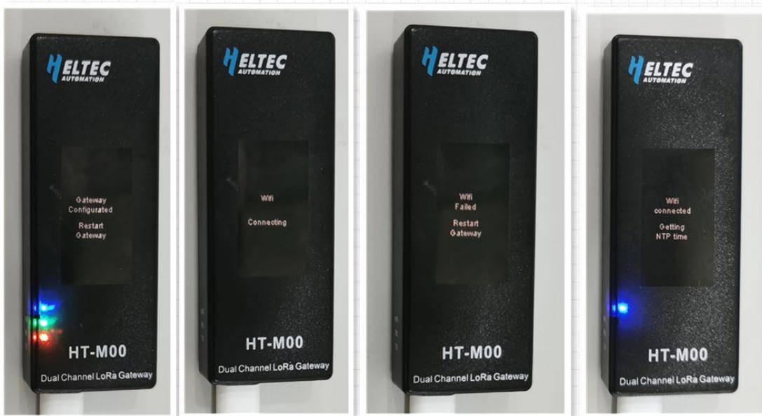
Figura 54 Proceso de inicialización y conexión del gateway HT-M00 [40]
