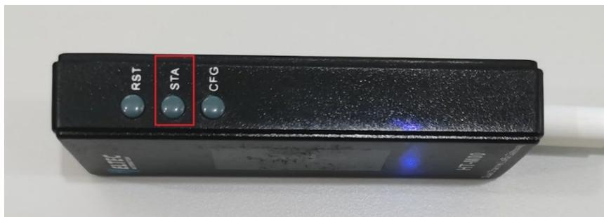
Figura 56 Ubicación boton STA del gateway HT-M00 [40].
