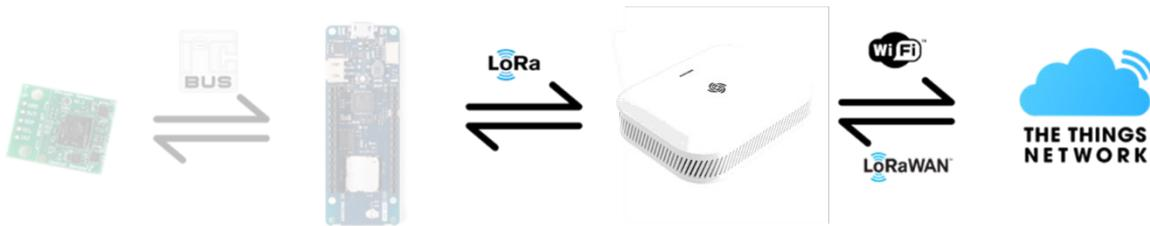
Figura 49 Arquitectura de integración del dispositivo Arduino MKRWAN 1310 y el módulo Person Sensor con la plataforma IoT TTN, con los Gateways LoRaWAN HT-M00 y RAK7268.
