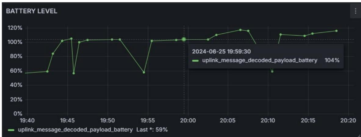
Figura 192 Nivel de Batería conectada al dispositivo Arduino MKRWAN 1310.
