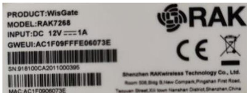
Figura 94 EUI del Gateway RAK en el revestimiento del dispositivo.
