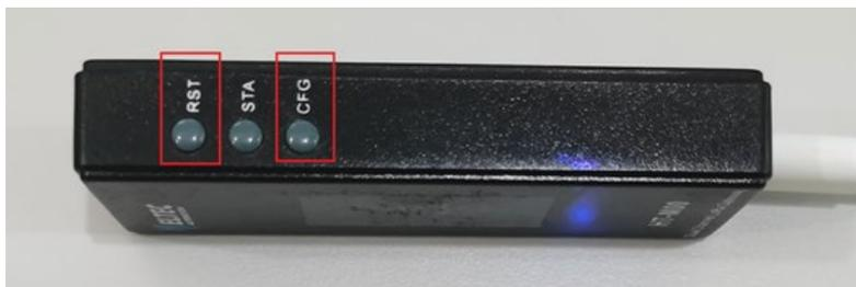
Figura 51 Ubicación de los botones de configuración en el gateway HT-M00 [40].
