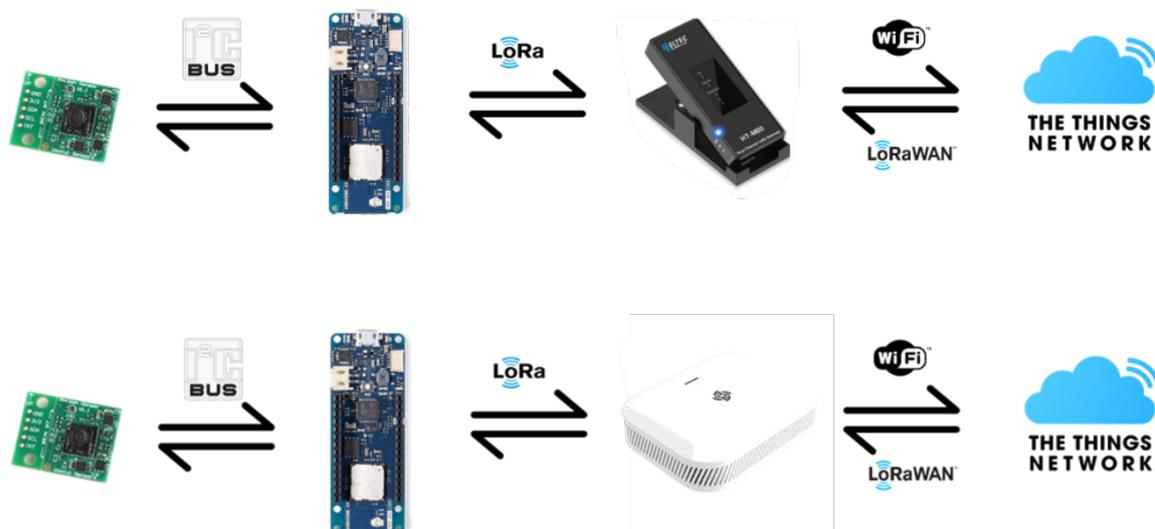
Figura 109 Arquitectura de integración del dispositivo Arduino MKRWAN 1310 y el módulo Person Sensor con la plataforma IoT TTN mediante los Gateways LoRaWAN HT-M00 y RAK7268.
