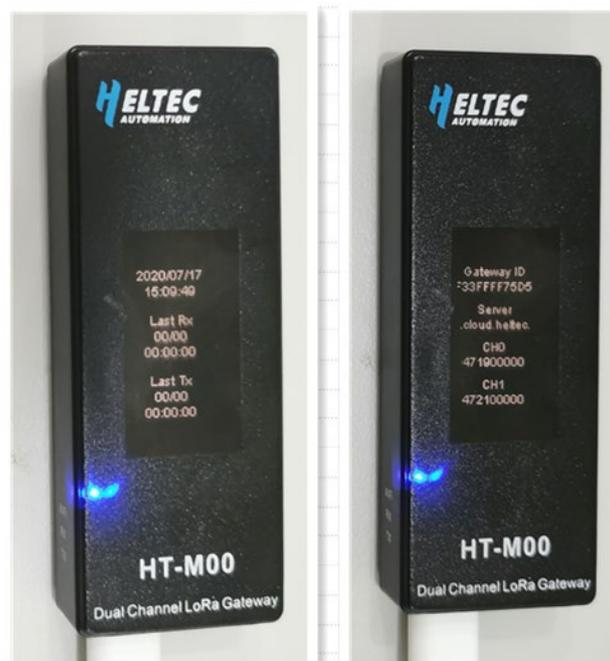
Figura 57 Información del gateway HT-M00 a través de la interfaz de estado [40].
