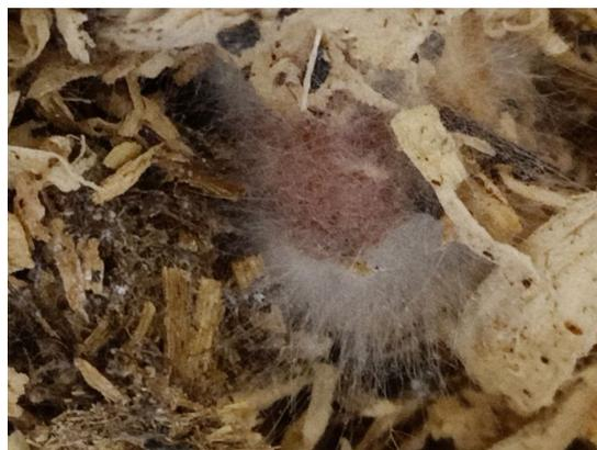
Figura 6.3. Hongo con estructura micelial desarrollado durante el ensayo de desintegración
