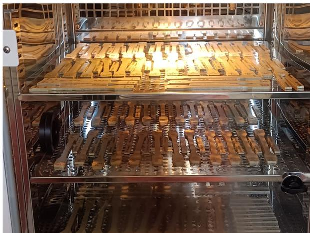
Figura 6.19. Distribución de las probetas en la cámara climática
