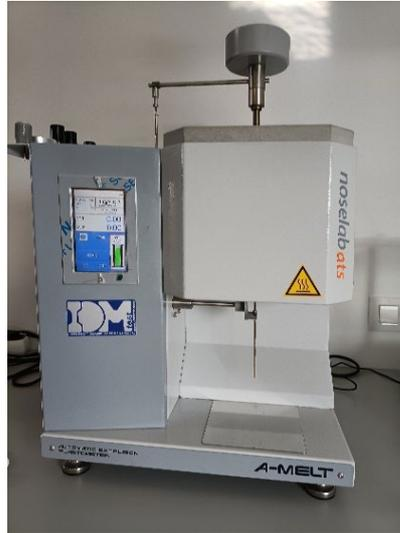
Figura 3.9. Medición del índice de fluidez
