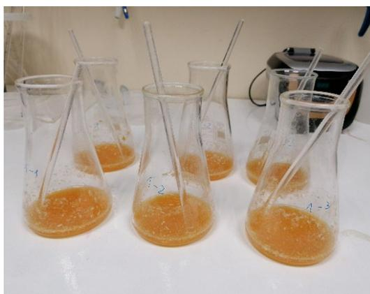
Figura 3.3. Ensayo de determinación de celulosa
