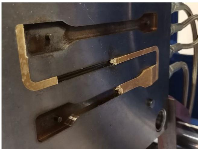
Figura 5.8. Rotura de probetas durante la inyección de PLA.PS.30
