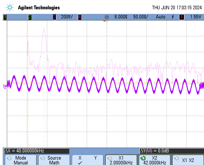
Figura 36: Potencia de señal en la entrada del receptor de -65 dBm
