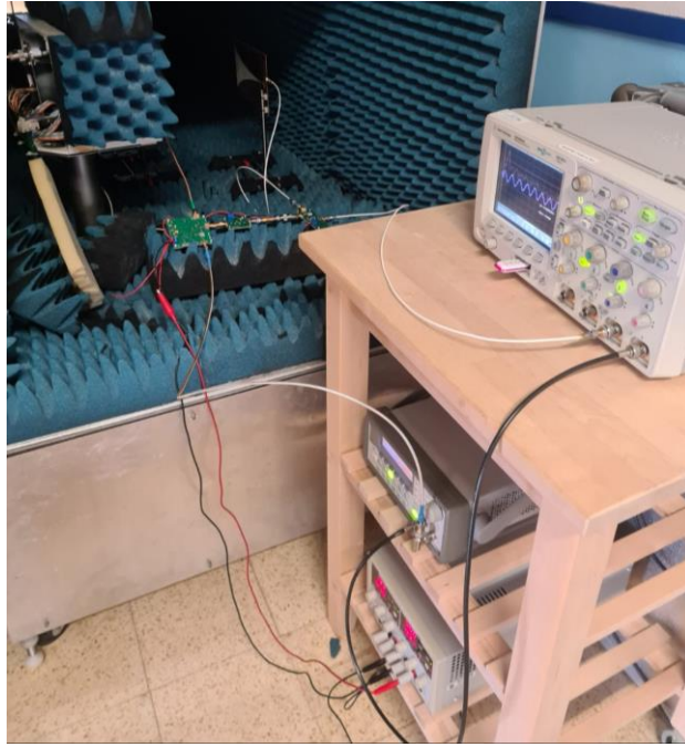
Figura 44: Montaje de medidas del Tx-Rx en la cámara anecoica
