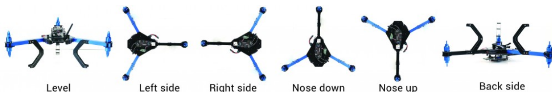
Figura 20: Calibración del acelerómetro.
