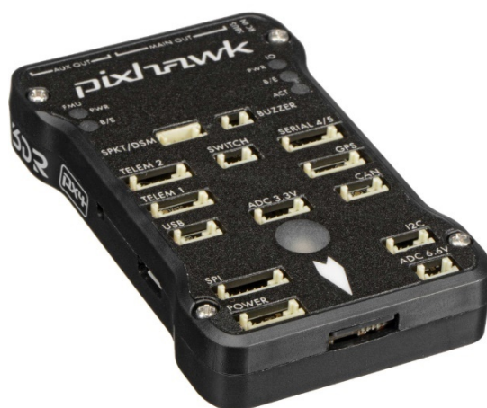
Figura 31: Parte frontal de la Pixhawk.
