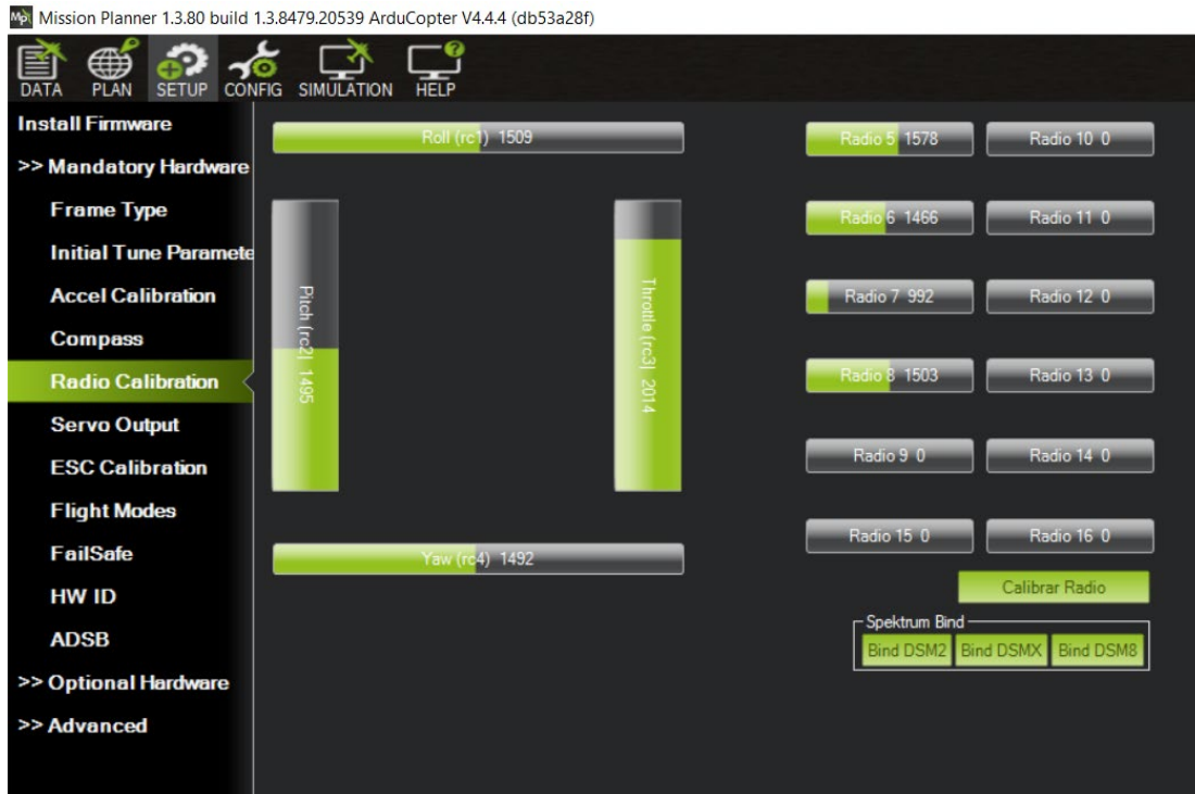
Figura 21: Calibración del radio control.
