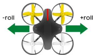
Figura 7: Ángulo de navegación, Roll [11].
