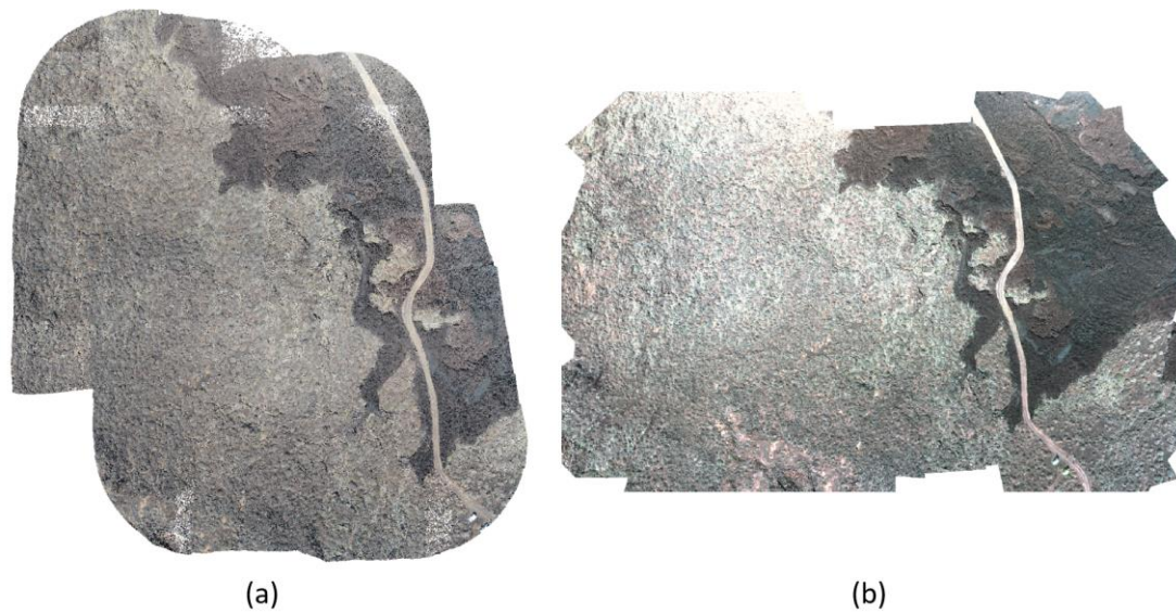
Figura 4.3. Productos de Timanfaya del 02/11/2023 para la monitorización terrestre: (a) nube de puntos LiDAR Zenmuse L1 con coloración RGB, (b) imagen multiespectral MicaSense Dual.
