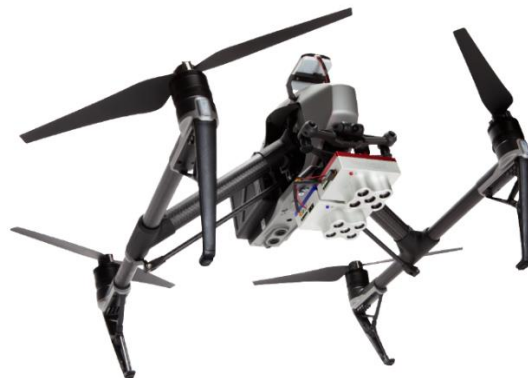
Figura 2.8. Representación del sensor Micasense Dual a bordo de un dron.
