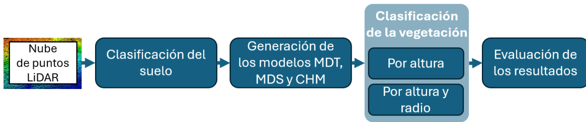
Figura 4.5. Esquema general de la metodología utilizada para la caracterización del suelo mediante nube de puntos LiDAR.
