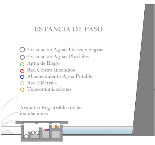
Esquema de canalización de las instalaciones
