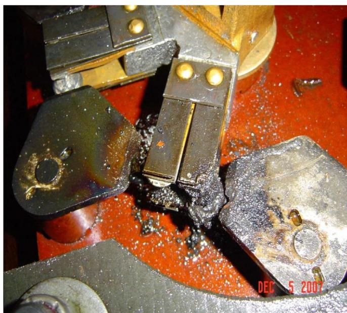
**Figura 3.6** Erosión de los contactos del preselector en un OLTC.
