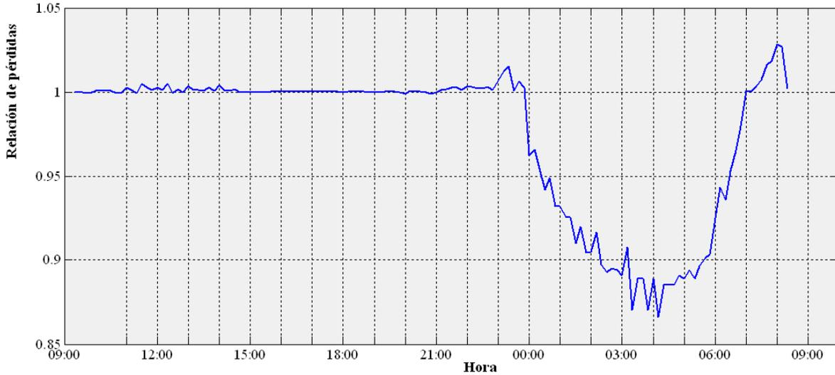
**Figura 3.21** Relación entre las pérdidas en la red de transporte con VVC basado en OPF y en lógica difusa.
