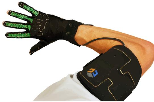
Figura 2.4. CyberGlove III usado para el control del Robots
