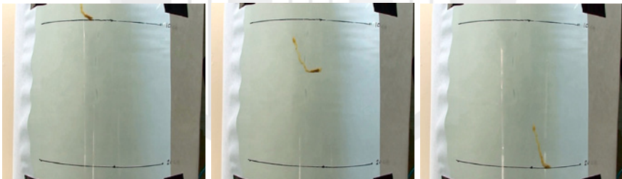
Foto 20. Heces de corvina entrando en la zona de medición Foto 21. Heces de corvina atravesando la zona de medición Foto 22. Heces de corvina saliendo la zona de medición (fin) (inicio)
