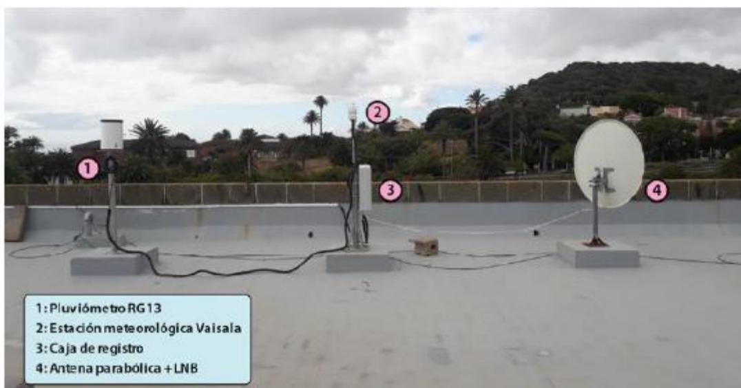
*Figura 13. Estación meteorológica y antena.
