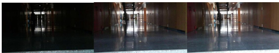
Figura 5.2.1.1: Escenario indoor con tiempo de exposición de 9 (izquierda), 14 (medio) y 19 ms (derecha)
