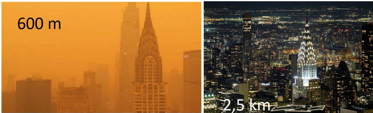
Figura 2.2.1.1: Edificio Chrysler ante nube de humo naranja con una máxima distancia de enlace óptico de 600 metros a la izquierda, y edificio Chrysler en noche despejada con una máxima distancia de 2,5 kilómetros a la derecha
