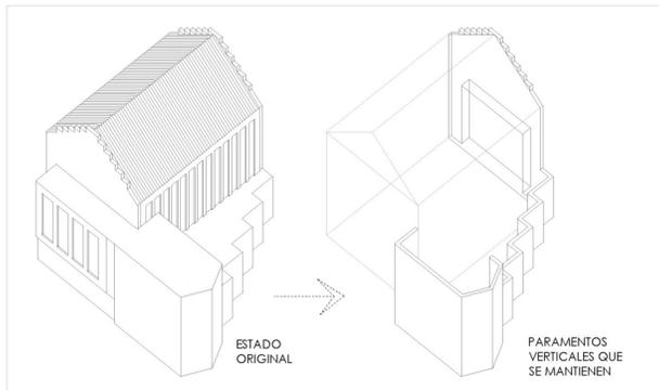
**SISTEMA ESTABILIZADOS DE FACHADA CON ELEMENTOS ALIGERADOS**
