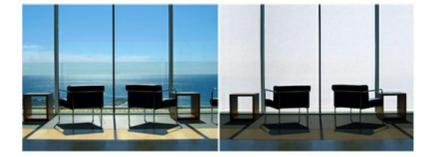
LAS IMÁGENES INFERIORES MUESTRAN EJEMPLOS DE UN VIDRIO LAMINADO QUE CAMBIA SU ESTADO DE OPACO A TRANSPARENTE CON SÓLO PULSAR UN INTERRUPTOR. PUEDE APLICARSE TANTO PARA INTERIORES (MAMPARAS, PUERTAS, SUELOS, PUERTAS AUTOMÁTICAS O CORREDERAS, ETC.), ADEMÁS DE EXTERIORES COMO EN ESTE CASO. SU USO EN EL EXTERIOR ES IDEAL YA QUE DISPONE DE PROTECCIÓN CONTRA LOS RAYOS UVA.
