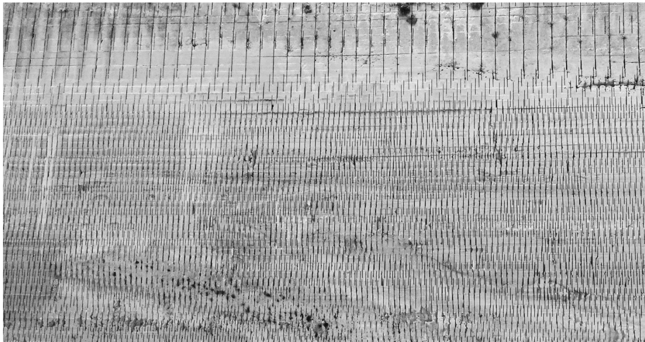
Fig. 92. Retícula de cortes que caracterizan las paredes de la cantera. Elaboración propia
