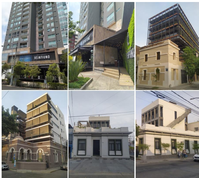
Fig. 30. Fincas ubicadas en los sectores Oeste del perímetro B de Guadalajara y ocupadas por bloques multiplanta realizados con soluciones de fachadismo y retranqueamiento . Fotos del autor
