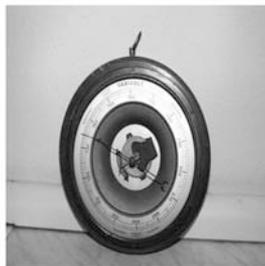
Se llama también metálico. Consiste en esencia en una caja metálica en la que se ha practicado el vacío y que tiene paredes elásticas. Como éstas tienden a aplastarse, debido a la presión atmosférica, se mantienen separadas por la acción de un resorte, el cual, a su vez, las amplifica mediante un juego de palancas y finalmente las traduce en el movimiento de una aguja sobre una escala graduada. Ésta se calibra por comparación con un barómetro de mercurio.
