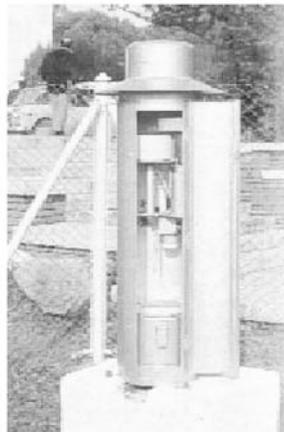
**Figura 10. Pluviógrafo***2.2.4. Temperatura*
