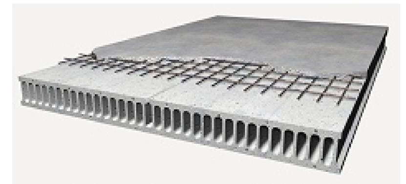
PLACA ALVEOLAR TIPO "ALVISA", SE UTILIZAN VARIOS ESPESORES UNO DE ELLOS ES e=35 + 5 cm. (35 de placa alveolar más 5 de capa de hormigón armado de compresión)
