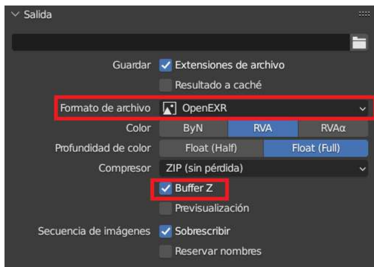
Ilustración 5.14: Configuración de las propiedades de la salida.
