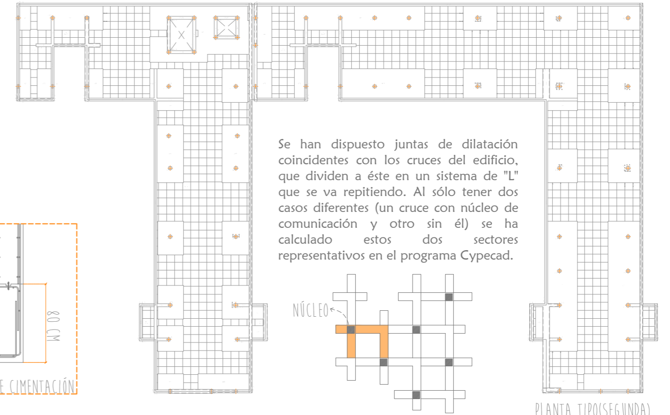
ARMADURA BASE EN ÁBACOS (POR CUADRÍCULA) SUPERIOR 2Ø10, INFERIOR 2Ø8
