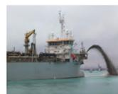
La draga estacionaria de succión es una draga hidráulica dotada de un mecanismo de succión sumergible, similares a las de succión en marcha. Sin embargo, a diferencia de las dragas de succión en marcha, las estacionarias operan ancladas.
