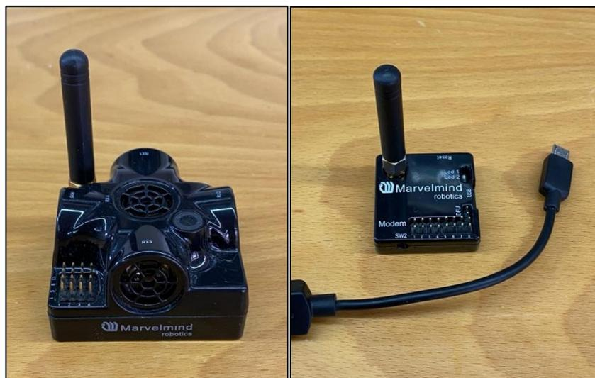
Figura 46. Baliza de ultrasonido y receptor de Marvelmind
