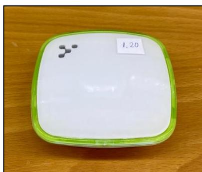
Figura 43. Baliza BLE de Kontakt.io
