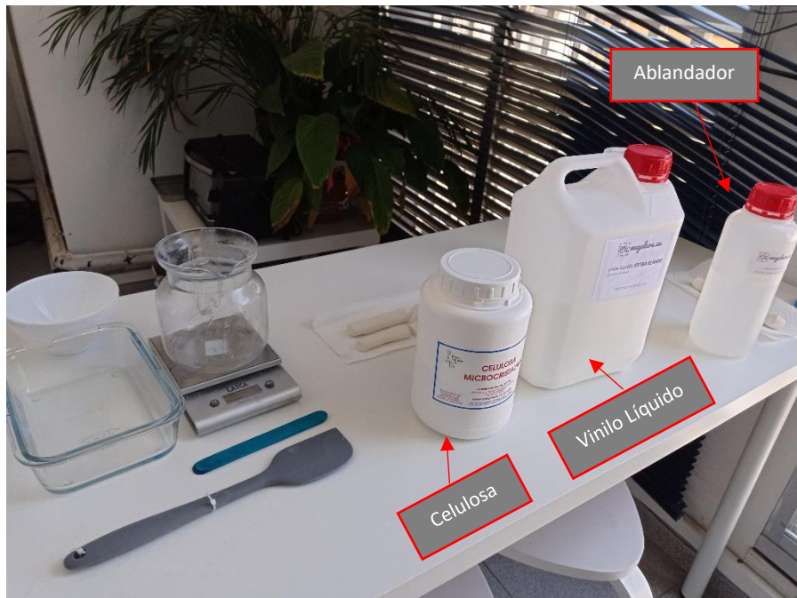
Fig. 4.8: Materiales empleados para la fabricación del fantoma.
