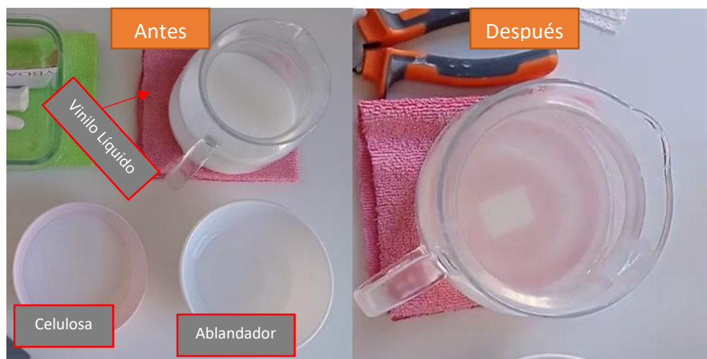
Fig. 4.9: Antes y después del vinilo tras haber sido introducido en el microondas. Como se aprecia, tras sacarlo del microondas se torna semitransparente.
