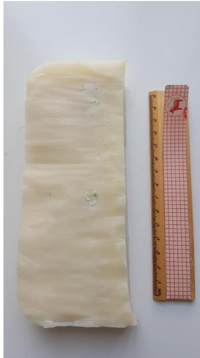
Fig. 4.13: Resultado de la extracción de burbujas de la superficie del fantoma.
