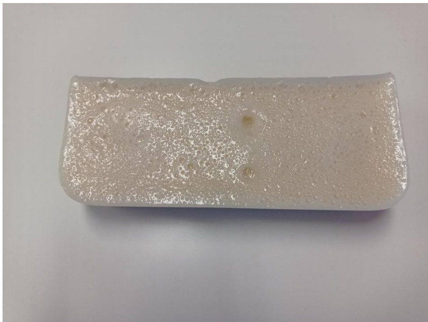
Fig. 4.12: Resultado final del fantoma tras el fraguado de la mezcla.
