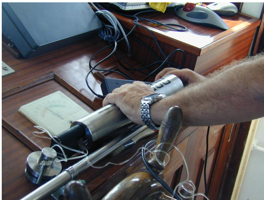
Fig. 11.- Descarga de los datos registrados mediante el dispositivo XR-420-CTD empleado para la toma de datos oceanográficos en todas las estaciones analizadas.
