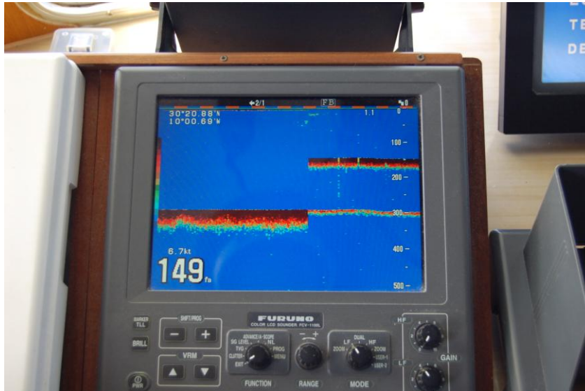
Fig. 7.- Ejemplo de ecograma tomado en los fondos llanos de la radial 1 (cerca de Agadir).
