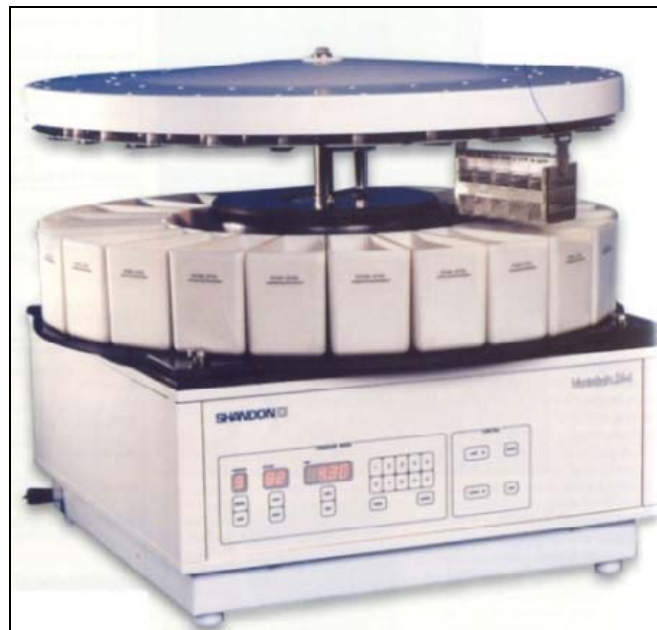
Fig. 2.4.- Teñidor automático Varistain 24-4 Thermo Shandon.
