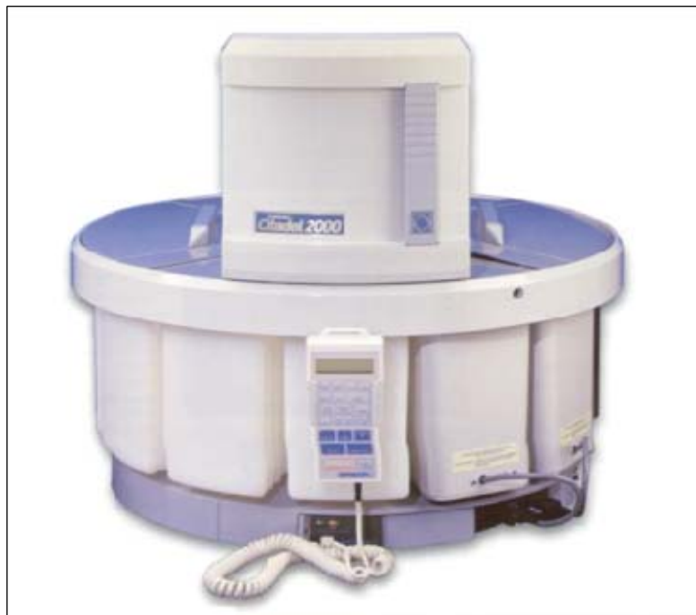
Fig. 2.3.- Deshidratador automático Citadel 2000 Thermo Shandon.
