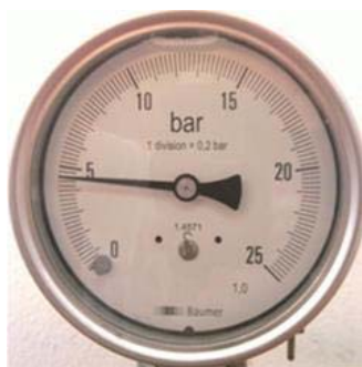
Figura 6.6. Manómetro Baumer tipo Bourdon.
