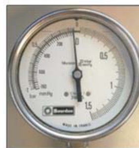
Figura 6.14. Manómetro Baumer tipo Bourdon, modelo Clase I.
