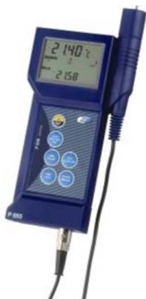
Figura 6.16. Lector digital de temperatura de Dostmann Electronics GmbH, modelo p655.
