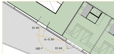
Con el fin de limitar el riesgo de propagación vertical del incendio por fachada entre dos sectores de incendio, entre una zona de riesgo especial alto y otras zonas más altas del edificio, o bien hacia una escalera protegida o hacia un pasillo protegido desde otras zonas, dicha fachada debe ser al menos EI 60 en una franja de 1 m de altura, como mínimo, medida sobre el plano de la fachada.
