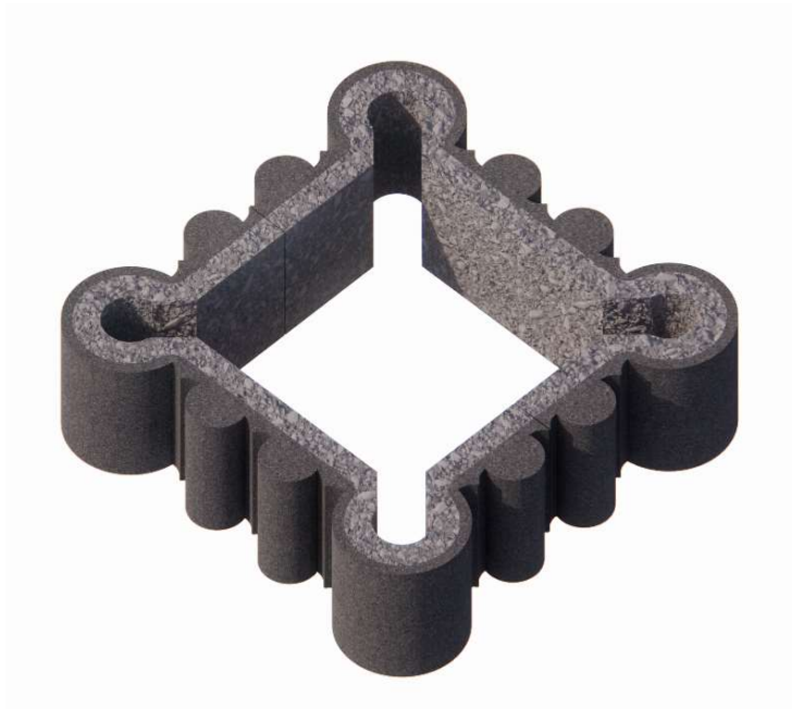
Figura 133: El molde prefabricado de las 8 columnas tipo de las naves. Dibujo de Hugo A. Ventura y Laura Trigo Ramírez
