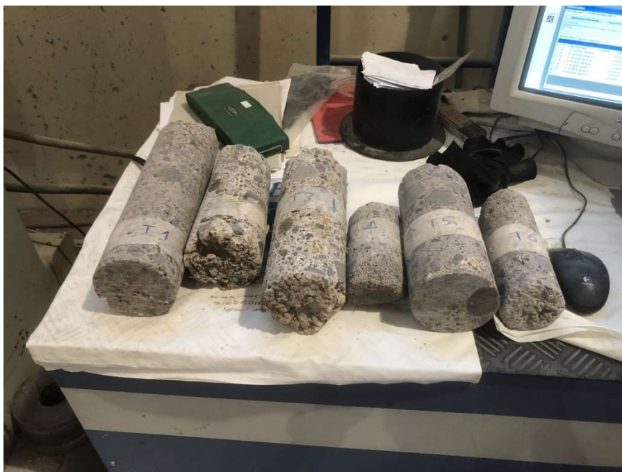
Figura 221, imagen de los seis testigos extraídos de los restos situados en el Seminario. El testigo T 1 corresponde a un arco, el resto fueron extraídos de las columnas del crucero.
