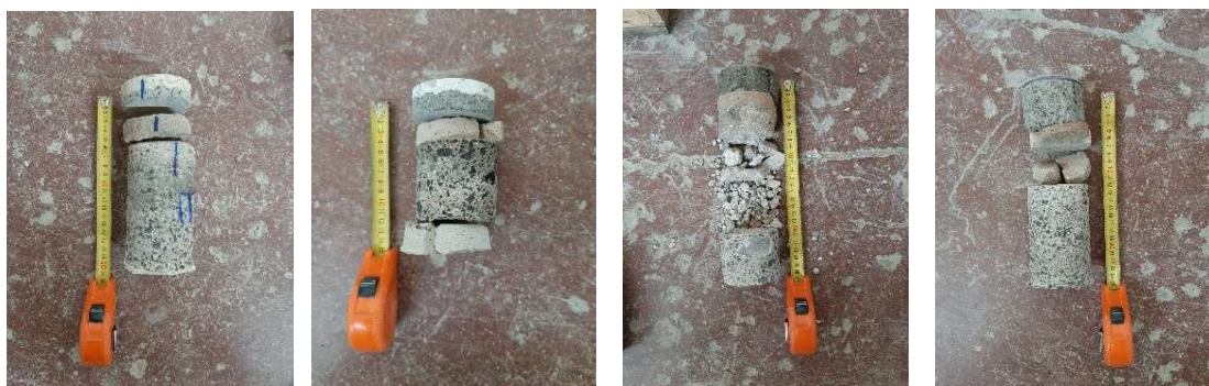
Figura 114, los testigos extraídos en el Convento de San José, de izquierda a derecha, 1,2,3,4. Fotos facilitadas por Labetec.
