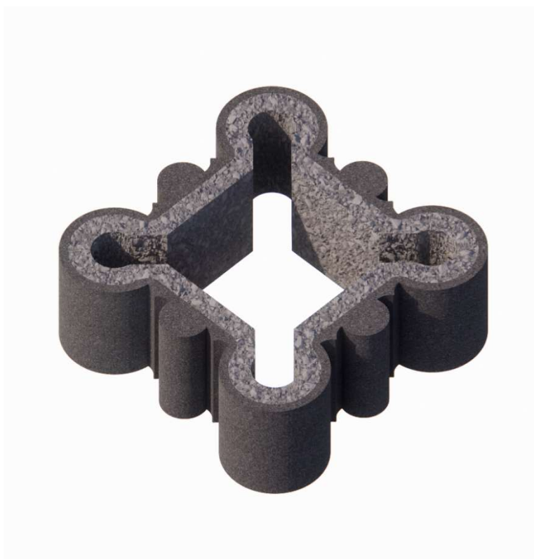
Figura 133: El molde prefabricado de las 8 columnas tipo de las naves. Dibujo de Hugo A. Ventura y Laura Trigo Ramírez
