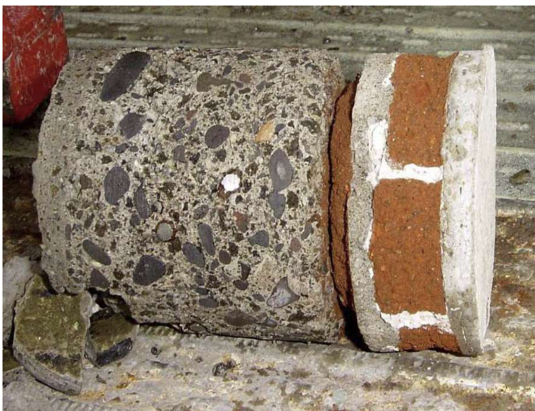
Figura 206, Fotografía del testigo extraído de la lámina de la cúpula con las dos capas de ladrillo de arcilla en la cara interior, ladrillos que se utilizaron como encofrado perdido. Imagen del informe de Peter Tanner realizado para el Ministerio de Cultura.
