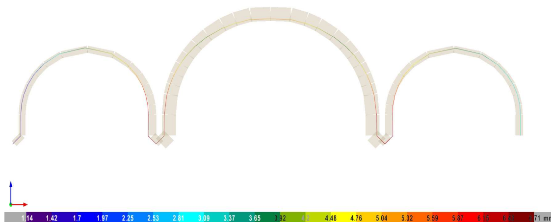
Figura 299 desplazamientos horizontales de las cabezas de los pilares en alineación del arco este. Programa Cype 3d
