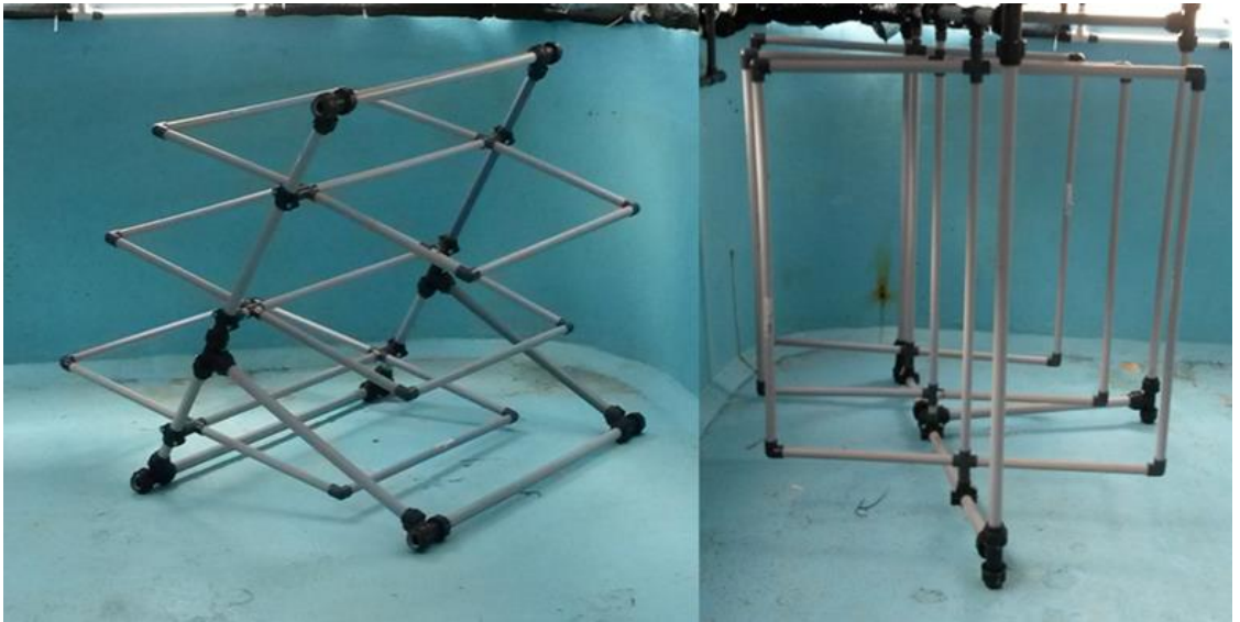
Figura 3. Armazón de los sustratos, adaptables a dos configuraciones, a la derecha en posición vertical y a la izquierda en horizontal, antes de cubrirse los paneles por la malla de fibra de vidrio.
