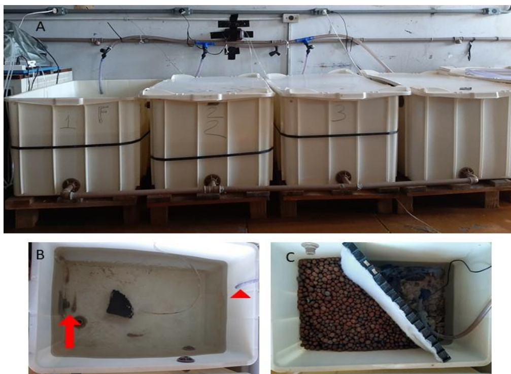
Figura 1. Sistema recirculado. A. Os três tanques do sistema recirculado com suas identificações 1,2 e 3, a caixa sem identificação é o filtro. B. Detalhe de um dos tanques mostrando a saída de água (seta) e a entrada de água (cabeça de seta). C. detalhe do filtro.
