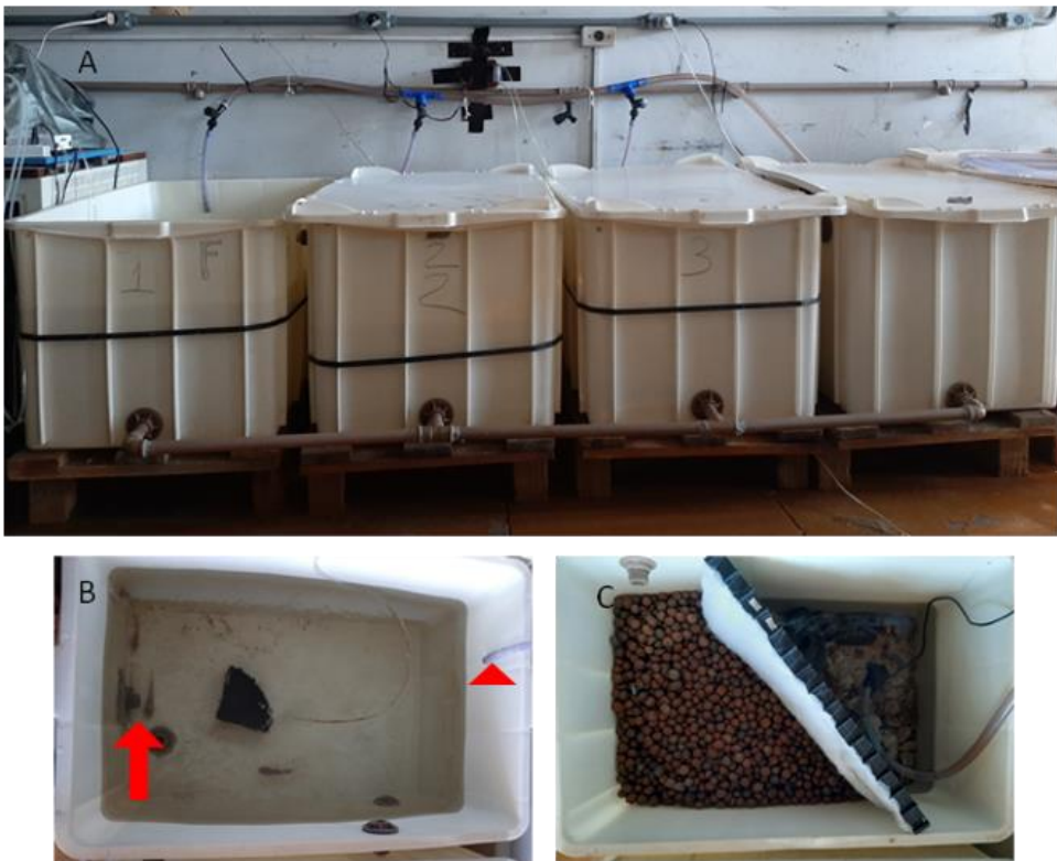
Figura 1. Sistema recirculado. A, os tanques numerados receberam os jundiás e a caixa à direita é o filtro. B, detalhe de um dos tanques mostrando a saída de água (seta) e a entrada de água (cabeça de seta). C, detalhe do filtro.
