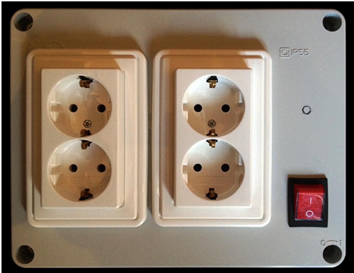
Ilustración 41: Frontal de la caja con las bases de enchufe y el interruptor instalados
