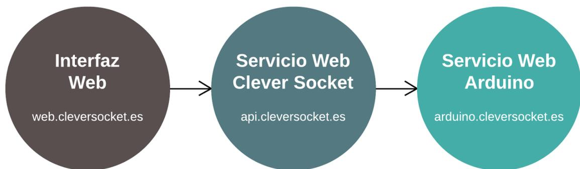
Ilustración 36: Componentes *software* de Clever Socket
