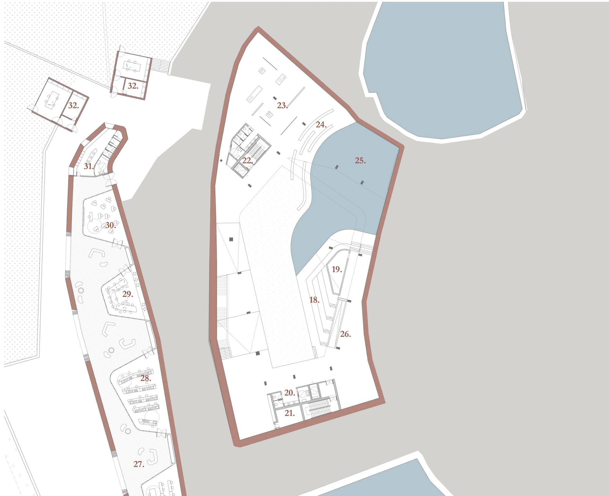
18. Graderío / 19. Cuarto de instalaciones / 20. Aseos y comunicación / 21. Cuarto de instalaciones / 22. Aseos y comunicación / 23. Área de exposición / 24. Espacio de visión / 25. Lámina de agua
