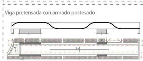
Ambas vigas de canto (0,8 x 3 m) serán pretensadas con el siguiente armado:
