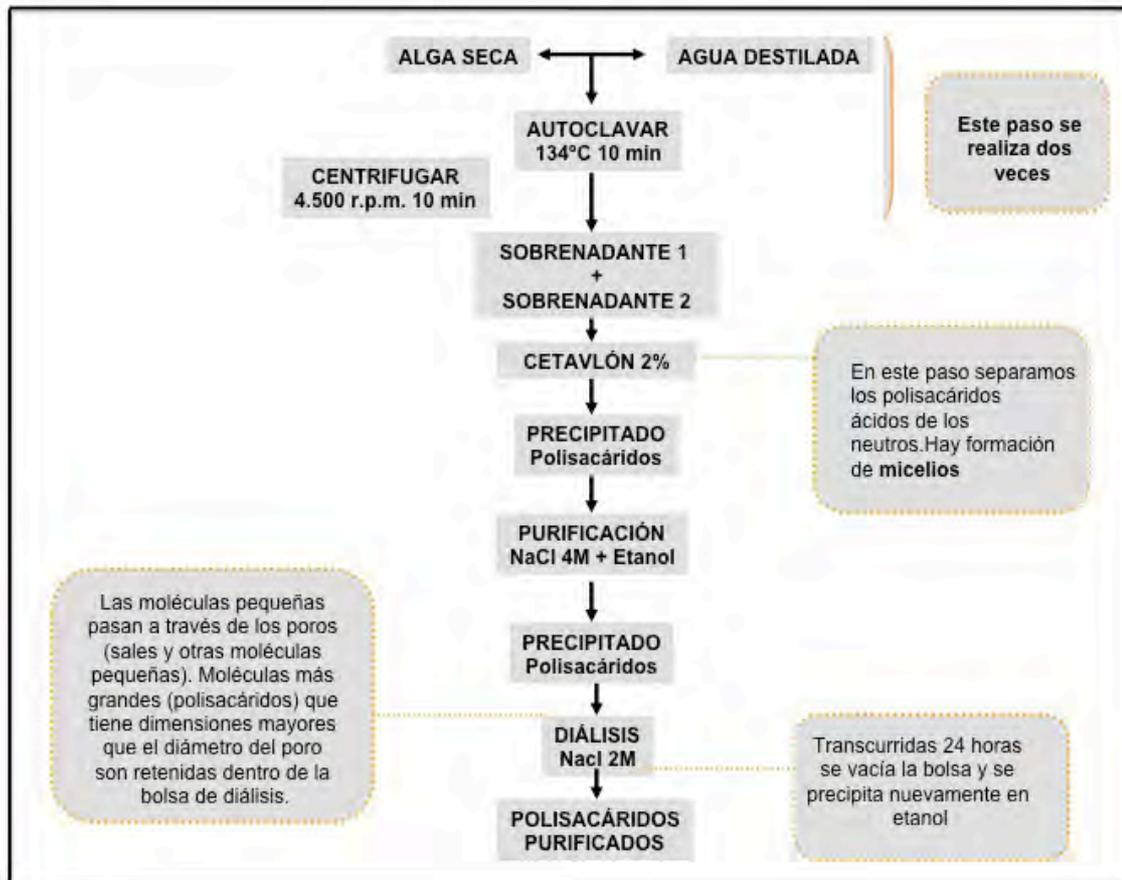
Figura 4.4. Protocolo de extracción y purificación de polisacáridos ácidos.
