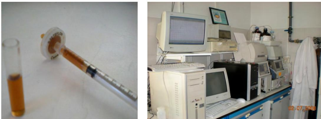
Figura 4.6. Filtrado de los extractos antes de la inyección y equipo de HPLC empleado con todos sus componentes.
