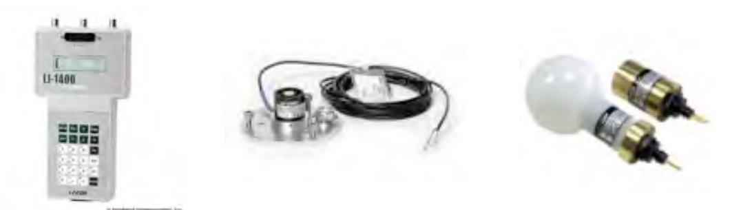
Figura 2.5. Equipo de trabajo (datalogger , adaptador, sensor esférico) con el cual se midió la radiación PAR que recibían las macroalgas en el fotobiorreactor. Las medidas de radiación de este equipo se toman en las unidades:  $\mu\text{moles de fotones m}^{-2} \text{ s}^{-1}$ .
