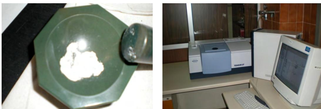
Figura 4.7. Homogeneizado del polisacárido y equipo de FT-IR empleado con todos sus componentes.
