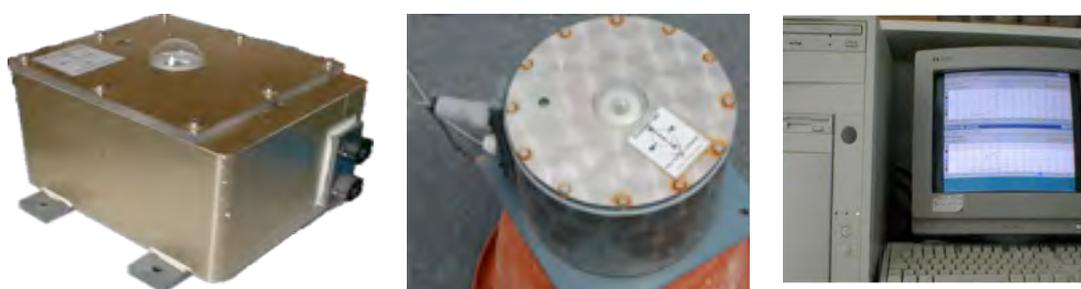
Figura 2.4. Equipo de trabajo con el cual se midió la irradiación solar recibida en las diferentes localizaciones de los cultivos de macroalgas: receptor del sensor Eldonet (European Light Dosimeter NETWORK), que aporta medidas continuas de la radiación solar incidente (PAR; UV-A; UV-B) ( $\text{W m}^{-2}$ ).
