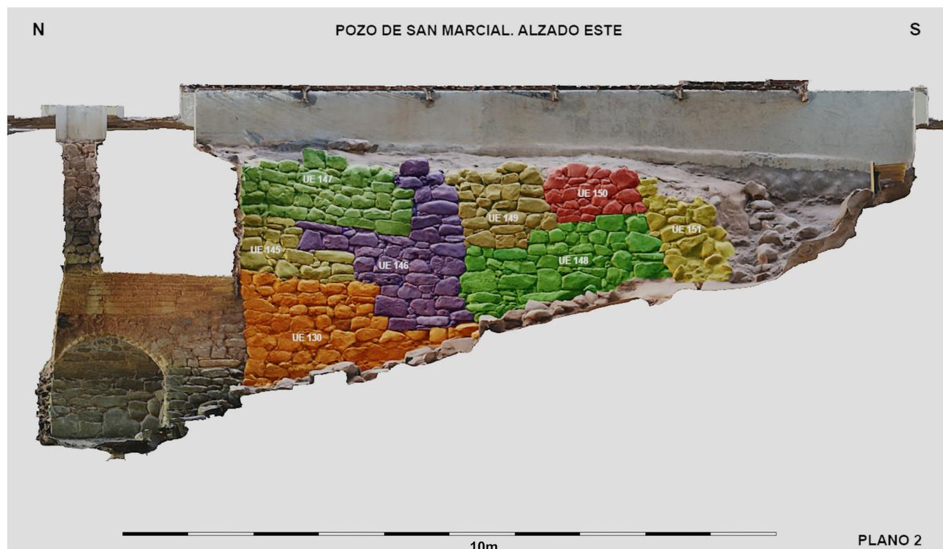
Figura 19. Ortoimagen de alzado del flanco este del pozo de San Marcial, con el desarrollo completo del muro oriental de contención de la rampa. Fotografía Archivo Proyecto Rubicón.
