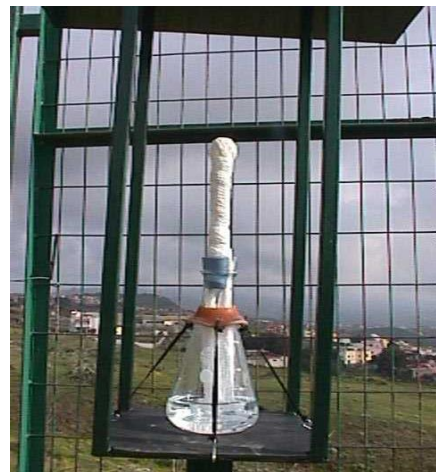
Figura 3. Dispositivo de vela húmeda para la captación de cloruros del aerosol marino
