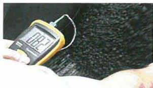
**Figura 13** - Temperatura alla stesa di conglomerato tiepido prodotta secondo il processo LEA e aspetto della realizzazione finale
