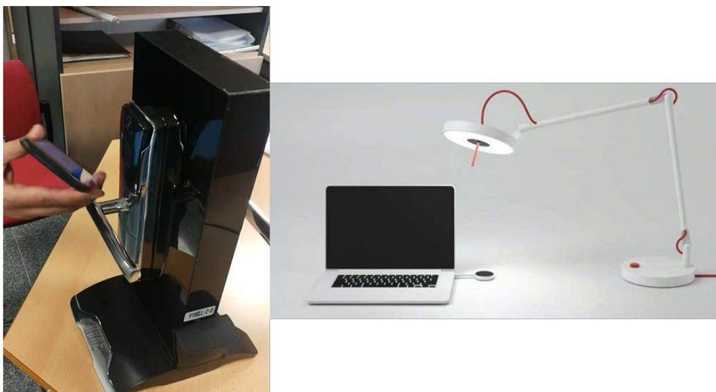
Figura 4. aplicación de *check-in* automatizada basada en dispositivos ópticos para teléfonos inteligentes, desarrollada por LIGHTBEE®, y lámpara para servicio VLC creada por OLEDCOMM®
