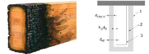
Figura E.1. Definición de la sección residual y eficaz.
