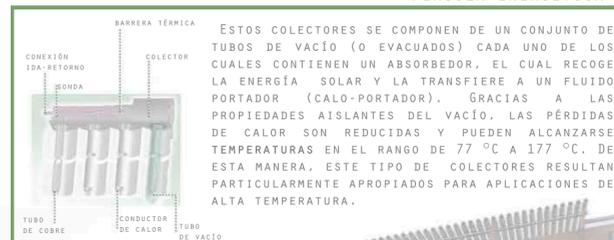
ESTOS COLECTORES SE COMPONEN DE UN CONJUNTO DE TUBOS DE VACÍO (O EVACUADOS) CADA UNO DE LOS CUALES CONTIENEN UN ABSORBEDOR, EL CUAL RECOGE LA ENERGÍA SOLAR Y LA TRANSFIERE A UN FLUIDO PORTADOR (CALO-PORTADOR). GRACIAS A LAS PROPIEDADES AISLANTES DEL VACÍO, LAS PÉRDIDAS DE CALOR SON REDUCIDAS Y PUEDEN ALCANZARSE TEMPERATURAS EN EL RANGO DE 77 °C A 177 °C. DE ESTA MANERA, ESTE TIPO DE COLECTORES RESULTAN PARTICULARMENTE APROPIADOS PARA APLICACIONES DE ALTA TEMPERATURA.
