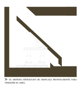
B- EL SISTEMA HIDRÁULICO SE DESPLAZA FRONTALMENTE PARA PERMITIR EL GIRO.
