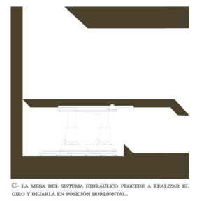
C- LA MESA DEL SISTEMA HIDRÁULICO PROCEDA A REALIZAR EL GIRO Y TRABAJA EN POSICIÓN HORIZONTAL.
