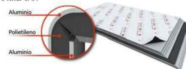
Las fachadas de panel composite permiten una ventilación continua a lo largo de toda la superficie del edificio, se consigue un ahorro energético de un 20 a un 40%, lográndose una menor absorción de calor en meses calurosos y un fuerte ahorro energético en los meses fríos.
